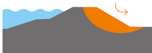
Figuur 1. Werking faalmechanisme macrostabiliteit binnenwaarts
