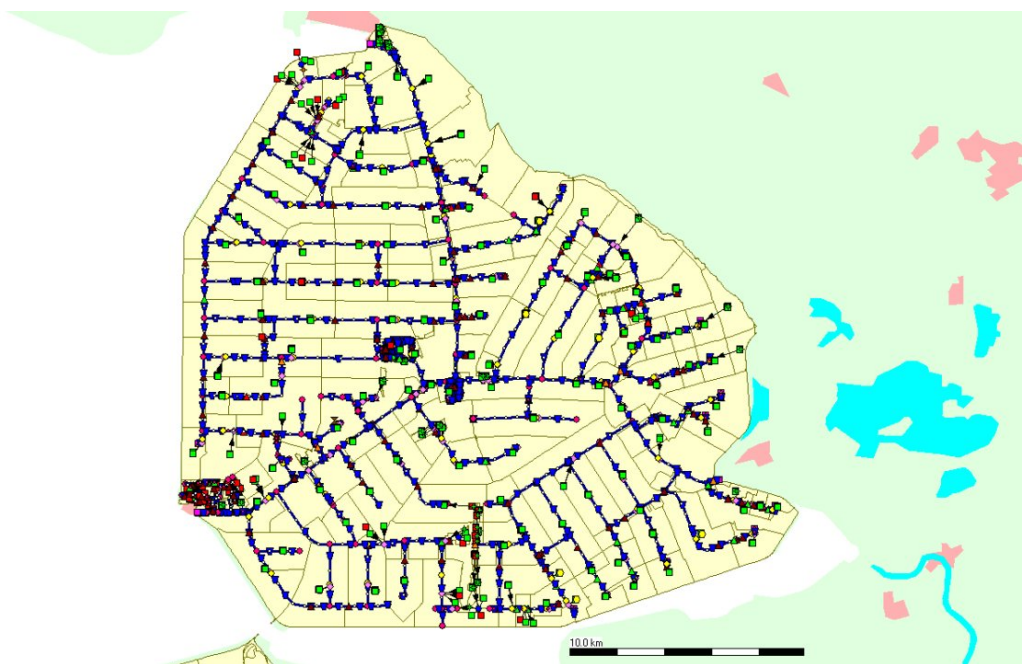
Figuur 1 Modelschematisatie in SOBEK van de Noordoostpolder.
